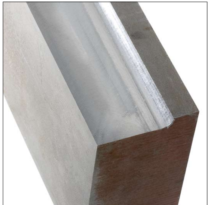
Frästeil mit ACC bearbeitet: Bei gleichem Vorschub und gleicher Schnitttiefe zeigt die Oberfläche keine Rattermarken. Die Bearbeitung erfolgte werkzeug- und maschinenschonend
