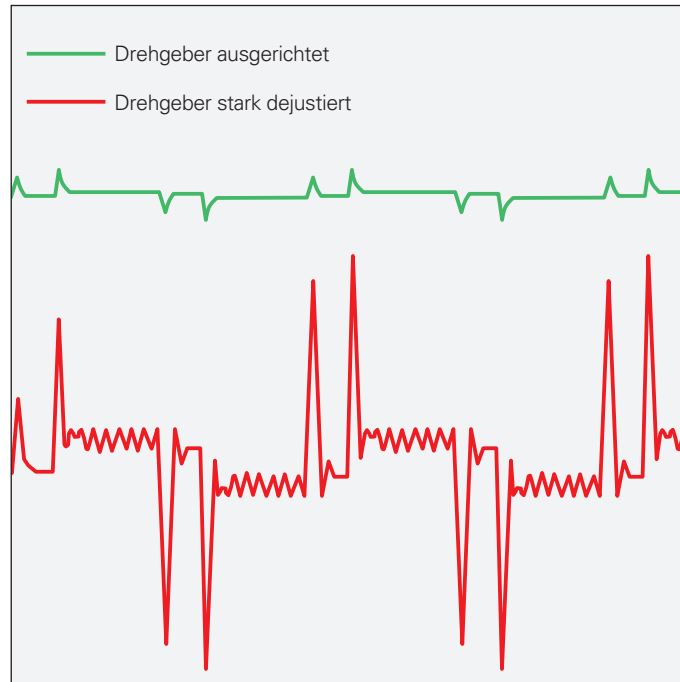
Motorstrom bei justiertem und stark dejustiertem Drehgeber
